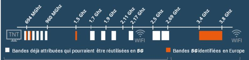
Fréquences « basses », bonne propagation à l'intérieur des bâtiments. Fréquences « hautes », propagation limitée à l'intérieur des bâtiments.
